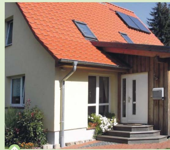
Bei diesem Anbau ist der Zugang seitlich angeordnet. Die Holzbekleidung des Anbaus ist als Boden-Deckel-Schalung aus Lärche ausgeführt, die mit dem zarten Gelbton der Putzfassade gut harmonisiert.
